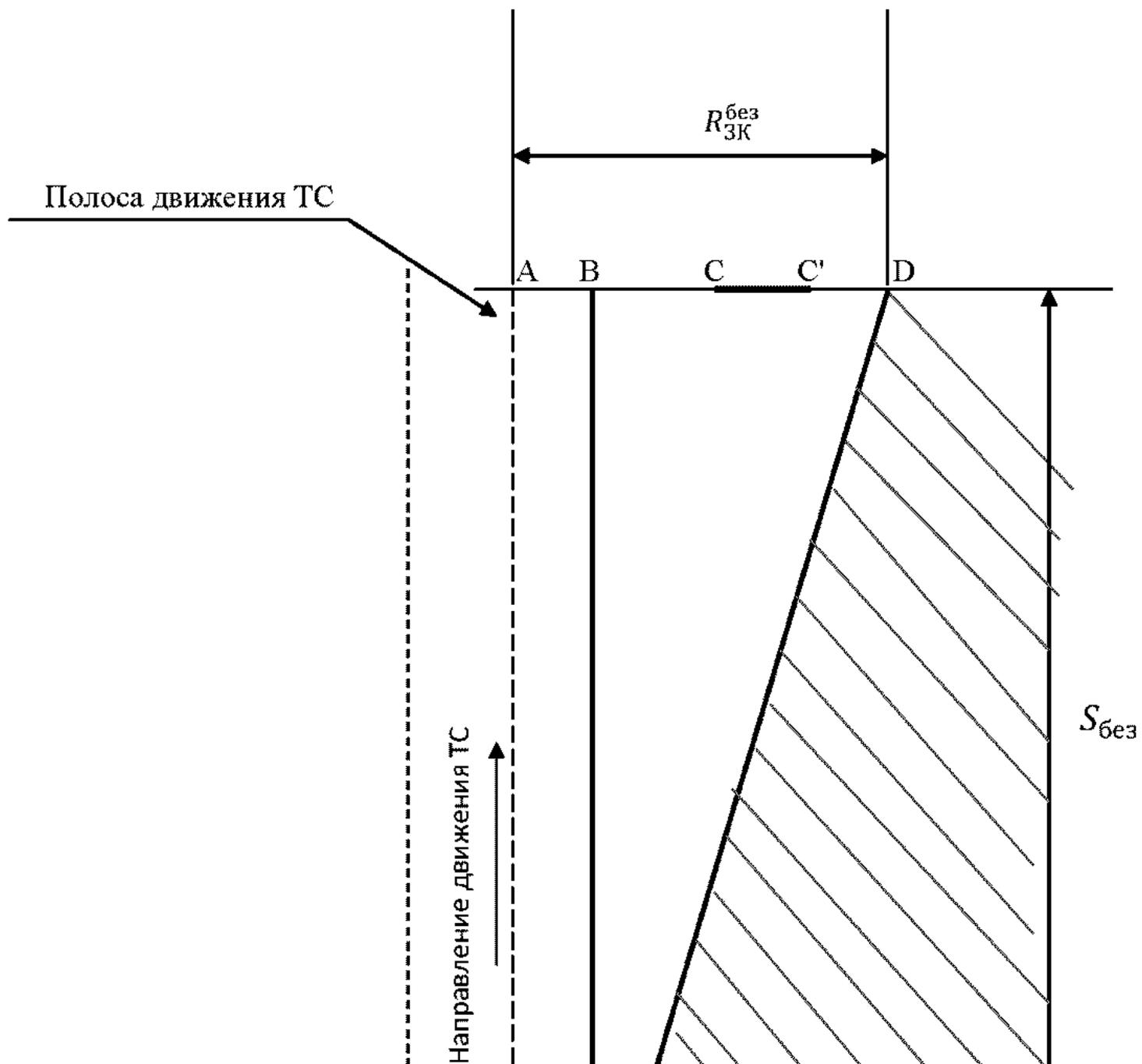
DGH - границы коридора безопасности; PB - край проезжей части; O' - транспортное средство; CC' - дорожный знак (светофор), предусмотренный Г.3.1, Г.3.2;  $R_{ЗК}^{без}$  - минимальное расстояние от середины крайней полосы движения, определяемое по формуле (Г.2), при котором обеспечивается видимость дорожного знака, предусмотренного Г.3.1, Г.3.2.
